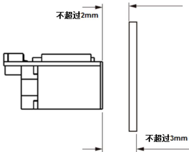
若窗口需倾斜设计，距离的要求与平行安装相同，倾斜角度应保证照明光束被玻璃反射的光不能反射进入镜头。
